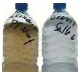
Photo 5 : à gauche : eau de vidange du circuit « médicament » à droite : eau de rinçage de la solution HYDROCARE® avec présence de bulles d'oxygène.
